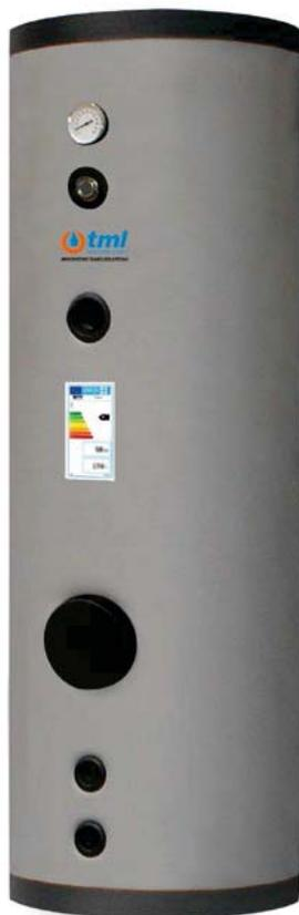
Il sistema è costituito da due serbatoi in un unico corpo: il serbatoio superiore è un bollitore per la produzione e lo stoccaggio di acqua calda sanitaria dotato di uno scambiatore di calore ad alta efficienza che può essere alimentato da pompa di calore mentre il serbatoio inferiore è un accumulo inerziale di acqua tecnica per il circuito del riscaldamento, alimentato sempre da pompa di calore.
