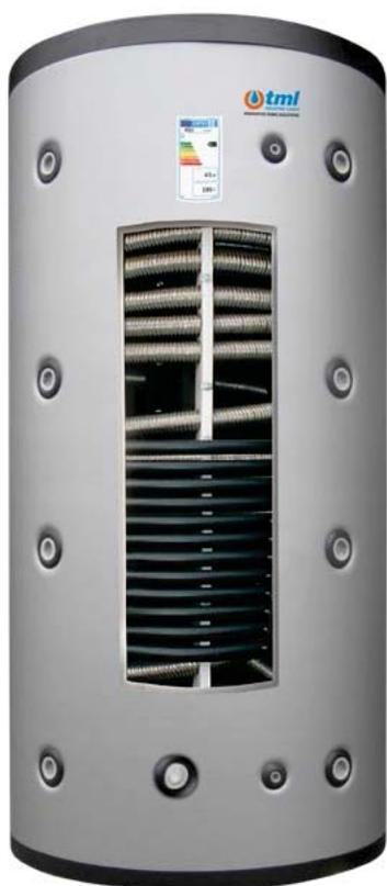
Termoaccumulo per lo stoccaggio di acqua da riscaldamento prodotta da sorgenti di calore continue o discontinue; produzione istantanea di acqua calda sanitaria (ACS) per mezzo di uno scambiatore di calore in acciaio Inox AISI 316L corrugato ad alta efficienza.
