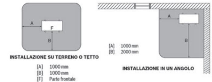
Le misure riportate sul manuale di installazione sono da considerarsi come le distanze ottimali per evitare in ogni condizione qualunque tipo di interferenza tra la pompa di calore e l'ambiente.
