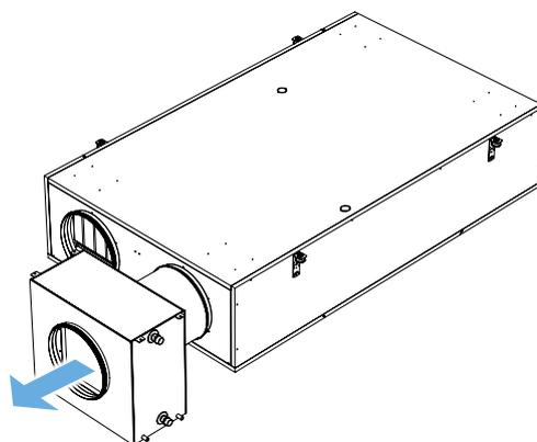
**SFE Sezione ausiliaria con prefiltro e filtro elettrostatico**
